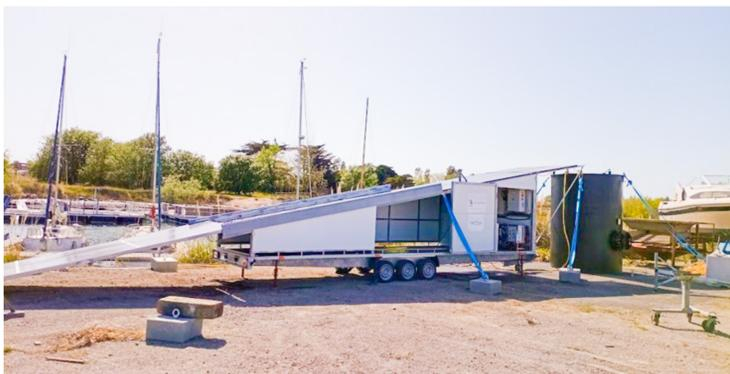
Les panneaux solaires permettent d'alimenter les équipements de production d'eau douce et de maintenir une dilution constante de la saumure. (Photo Sillages)
